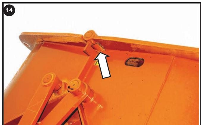
Grease Discharge Auger pivot
