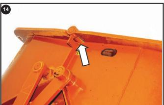
Grease Discharge Auger pivot
